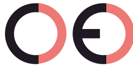
Falsche CE-Kennzeichnung (zu großer Zwischenraum)
