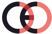
Falsche CE-Kennzeichnung (zu dicht)
